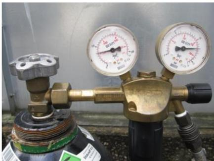
**Bild 1: Druckminderer an einer Druckgasflaschen**
