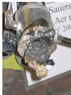
**Bilder 3 und 4 ausgebrannte Druckminderer**
